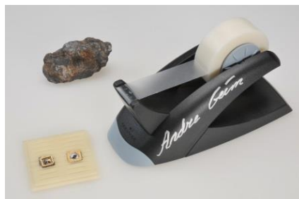
Abb. 104: Einer der ersten, von Geim und Novoselov hergestellten Graphentransistoren, ausgestellt im Nobelmuseum. Das Graphen wurde vom HOPG mit einem Klebeband abgezogen.
